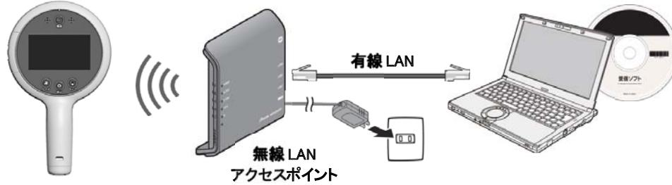
ぼうけんくんと無線 LAN アクセスポイント間は 2.4GHz 帯の無線 LAN で接続されます。干渉を避けるために、パソコンと無線 LAN アクセスポイント間は有線 LAN での接続を推奨します。
